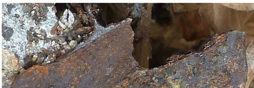
Figur 10. Detalje med friskt brudsnit (Udsnit fra figur 9).
